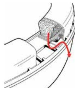
La technologie brevetée Air Flow Control offre une atténuation passive optimale, quelles que soient les fréquences, sans augmenter la taille ou le poids des coquilles. La chambre d'air brevetée du coussinet et le revêtement de haute technologie non-tissé gèrent le flux d'air à l'intérieur du casque pour contrôler la manière dont le son parvient à l'oreille. Résultat ? Une atténuation de meilleure qualité et plus régulière de presque tous les bruits des environnements sonores industriels.
